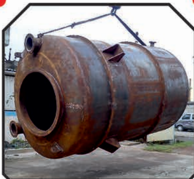
MS STORAGE TANK 25 KL
